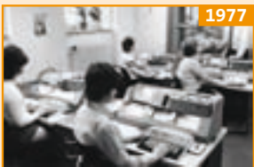
Lochkartenabteilung Bereits seit den zwanziger Jahren konnten standardisierbare Daten mit Hilfe von Lochkarten gespeichert werden (Hollerithmaschinen). Sie mussten an diesen Maschinen gestanzt werden.
