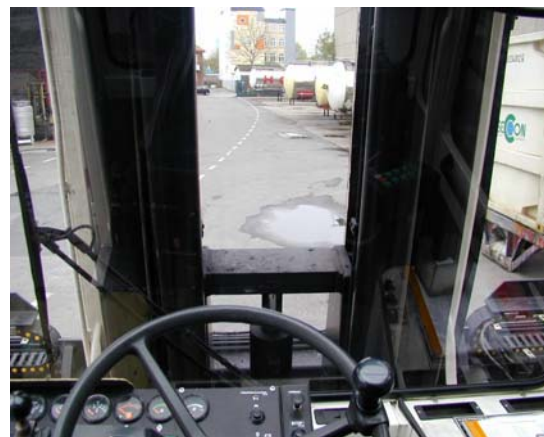
Unzureichende Sicht mit Triplex-Hubmast
