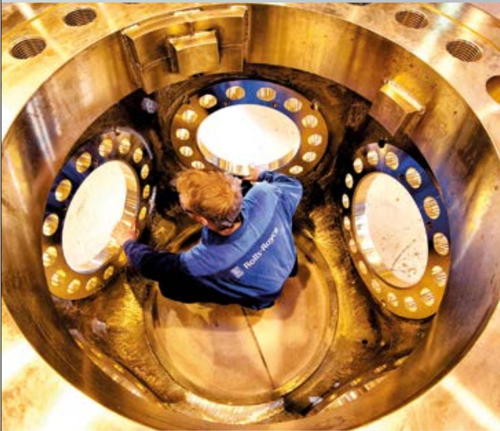
**JUSTIERUNG:** Gefräste Löcher in der Nabe erlauben eine stufenlose Einstellung des Propellerblattes.
