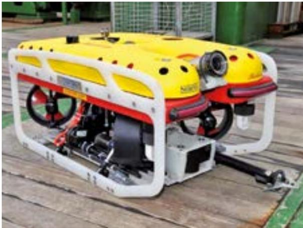
**ROV:** Mit Tauchrobotern kann ein Unterwasserhindernis auch bei unwirtlichen Außentemperaturen und starker Strömung erkundet werden.
