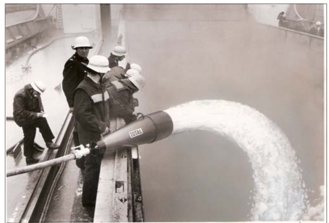
oben: Einsatz eines Schwertschaumrohres unten: Einsatz eines Mittelschaumrohres
