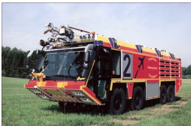
Löschfahrzeug der Flughafen Hamburg GmbH, 2008 Flughafenlöschfahrzeug 80/120-P500
