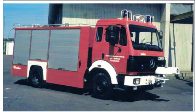
Tanklöschfahrzeug TLF 20/2-750 der Elbtunnelfeuerwehr (1996)
