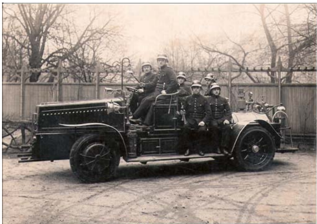
Gasspritze mit batterie-elektrischem Antrieb, 1908
