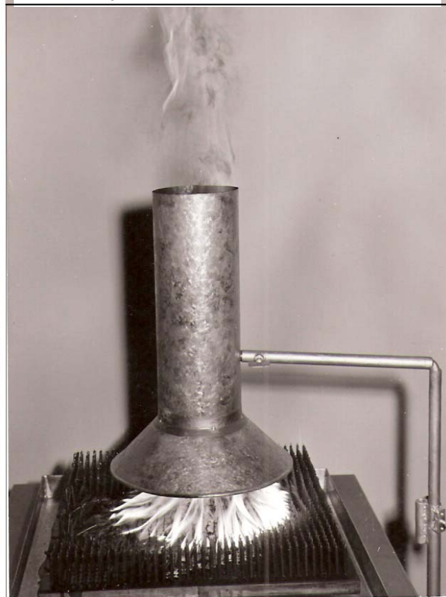
In der Kaminöffnung schießen die Flammen mit großer Wucht hoch. Die Flammenhöhe erreicht nahezu 2 m
