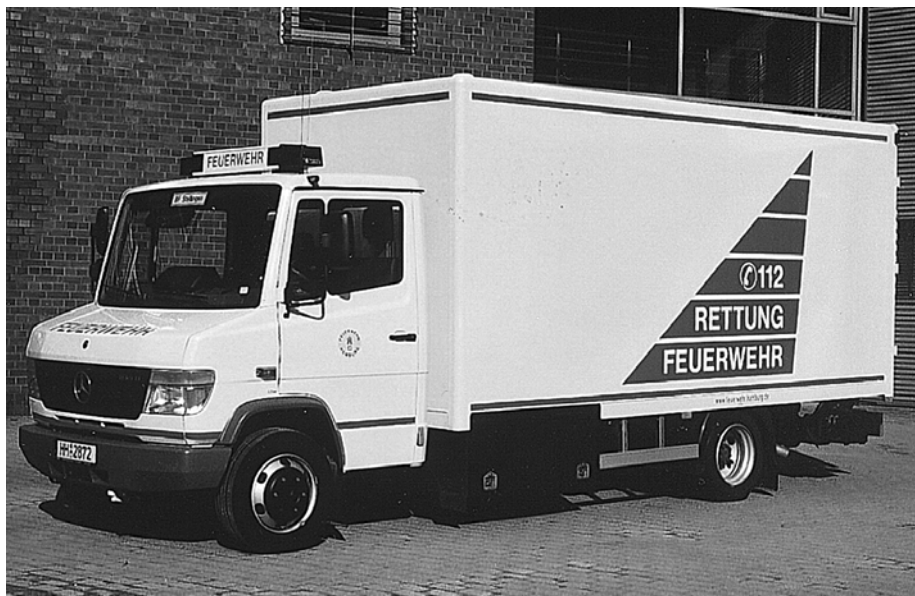
Einer der vier Gerätewagen „Rettungsdienst“, die 2005 beschafft wurden. Fahrgestell: Mercedes-Benz Vario 513D, Kofferaufbau: Ludewig (4)
