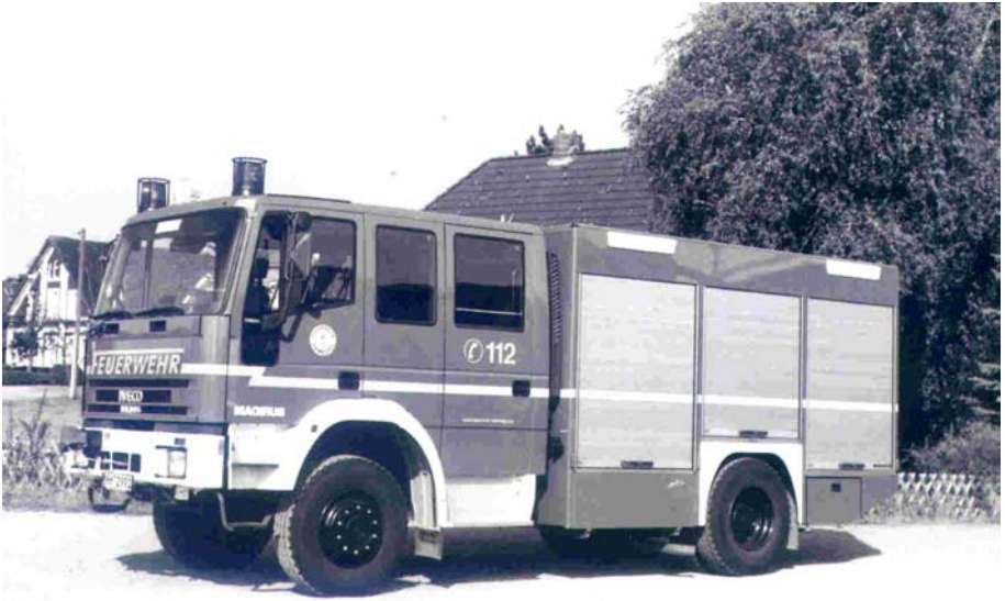
Einer von drei Gerätewagen (GKW 1), die 2002 beschafft wurden. Fahrgestell: Iveco-Magirus 135 E 24 W, Aufbau: Magirus (4)
