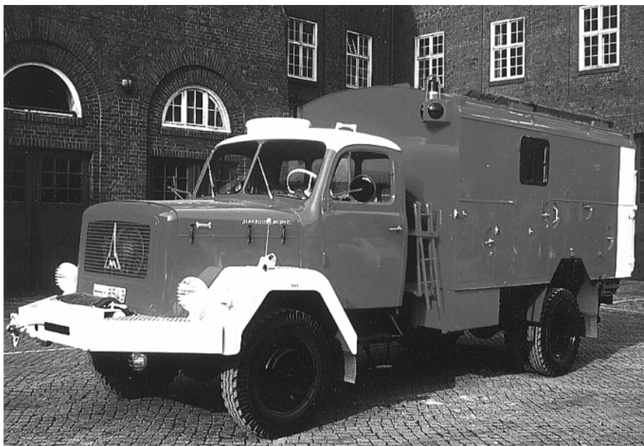
Einer der beiden Gerätekraftwagen (GKW) des Bundes, die bei der Berufsfeuerwehr vorübergehend im Dienst waren. Fahrgestell: Magirus-Deutz F Mercur 129 A-L (3)
