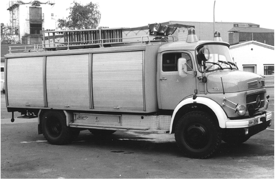
Einer der beiden Rüstwagen RW 2 Fahrgestell: Mercedes-Benz LAF 1113 B Aufbau: Metz. Im Dienst von 1971 bis 1984 (3)
