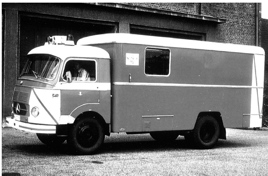
Atemschutzgerätewagen (ASGW) aus ehemaligen Gerätewagen Mercedes-Benz LPF 911. Umbau: 1970 durch die Fa. Schleede, im Dienst bis 1979 (4)
