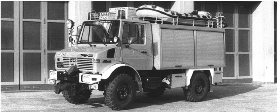
Rüstwagen RW 1 der 2. Generation, Beschaffung von 1983 bis 1987, Fahrgestell MB Unimog U 1300 L (4)
