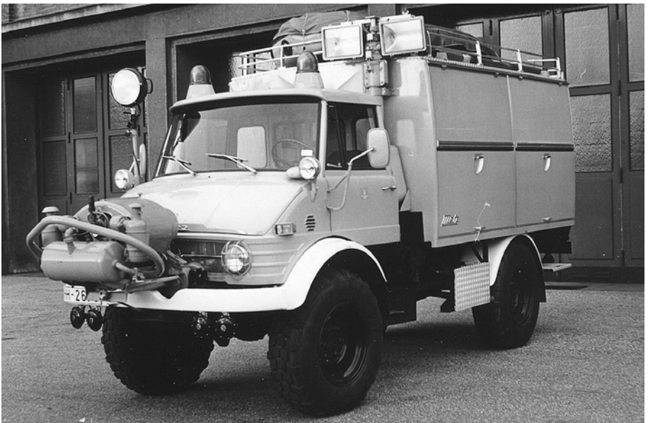
Rüstwagen RW 1 der 1. Generation auf Fahrgestell MB Unimog U 125, mit Vorbau-Kompressor (4)
