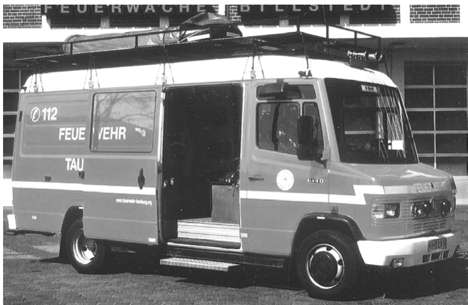
Gerätewagen „Tauchereinsatz“ ex NAW. Kastenwagen Mercedes-Benz 814 D, Umbau 2001 durch Fa. Schleede (4)
