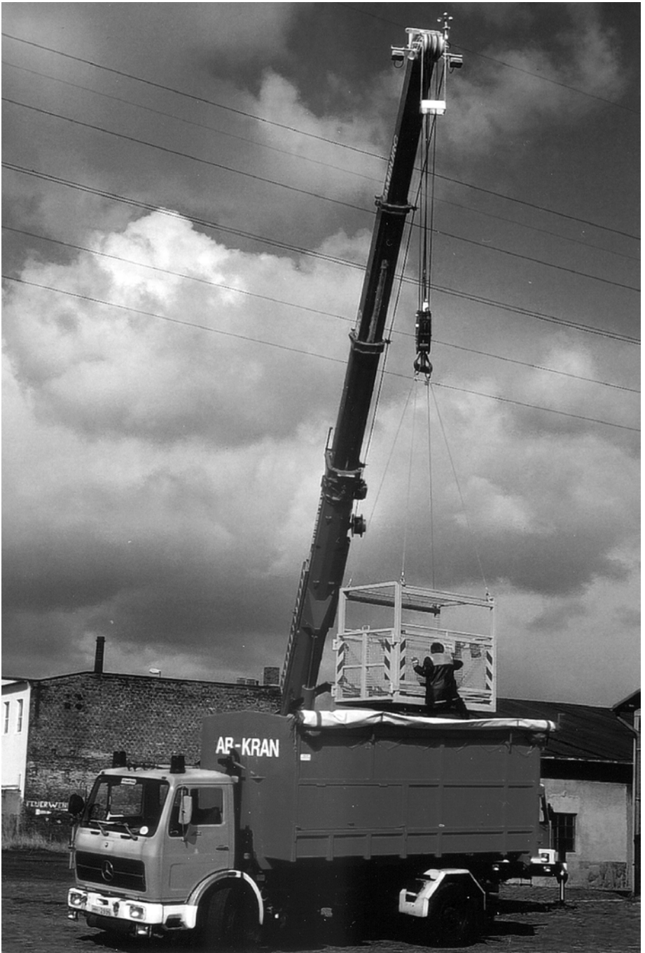
Abrollbehälter AB-Kran enthielt Anschlagmittel und einen Arbeitskorb (4)
