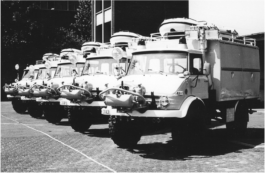
Rüstwagen RW 1 der 1. Generation Beschaffung von 1972 bis 1974 Fahrgestell MB Unimog U 125, Aufbau Metz (4)
