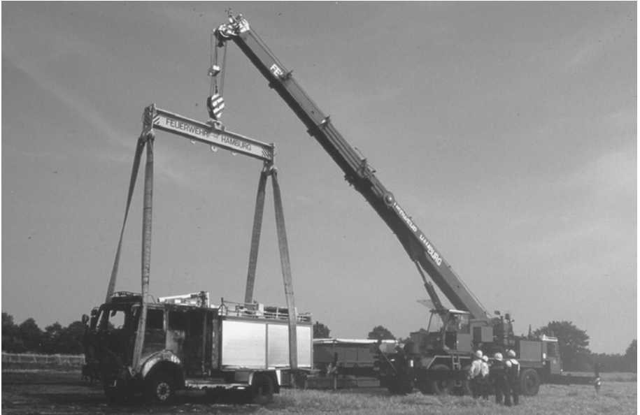
Bergung eines ausgebrannten TLF 16/25 durch den Liebherr-Kran LTM 1050 am 1. August 1992 (4)
