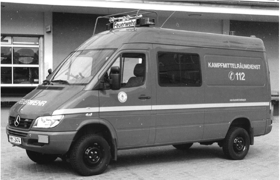
Einer von zwei Gerätewagen „Kampfmittelräumdienst“, Baujahr: 2003. Kastenwagen Mercedes-Benz Sprinter 311 D (4x4) (5)
