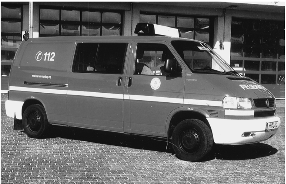
Einer der sechs Gerätewagen „Technische Einsatzleitung“, die 2003 in Dienst gestellt wurden. Kastenwagen VW T4 syncro 2,5 TDI Einrichtung: Firma TDS Invents (4)
