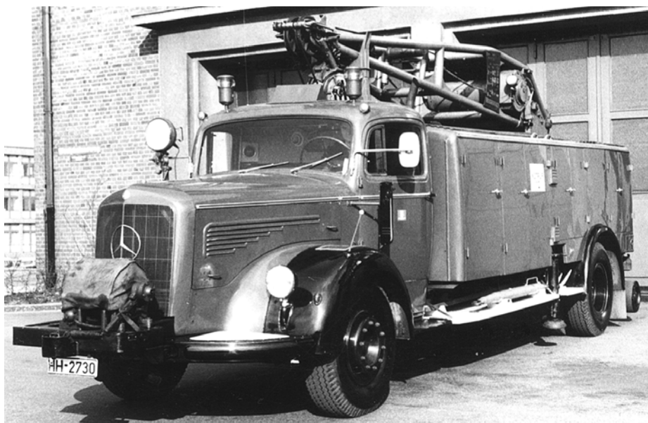
Der Rüstkranwagen RKW 10 von Metz. Fahrgestell: Mercedes-Benz L 6600. Im Dienst von 1953 bis 1971 (3)
