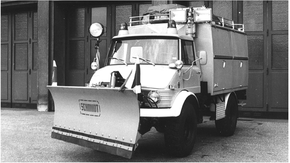
Rüstwagen RW 1 der 1. Generation auf Fahrgestell MB Unimog U 125, mit Schneeräumschild (4)
