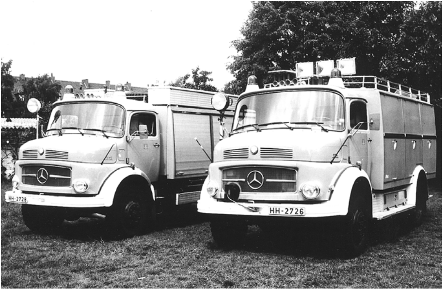
Äußerlich bis auf die Geräteraum-Verschlüsse (Rolladen, Falttüren) kaum ein Unterschied: links der RW-Öl, rechts ein RW 2 (4)
