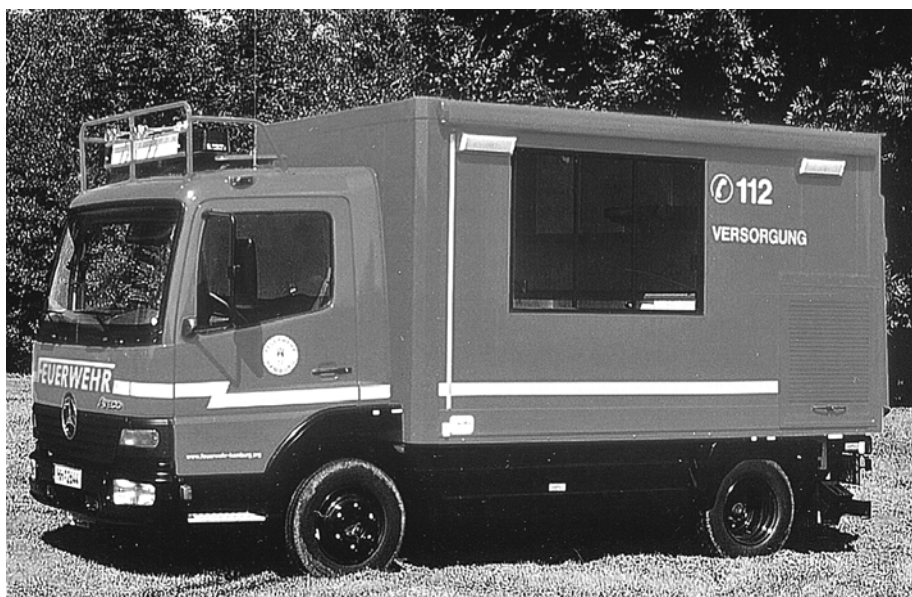
Gerätewagen „Versorgung“, Baujahr 2002, Fahrgestell: Mercedes-Benz Atego 812, Kofferaufbau: Firma Wille (4)
