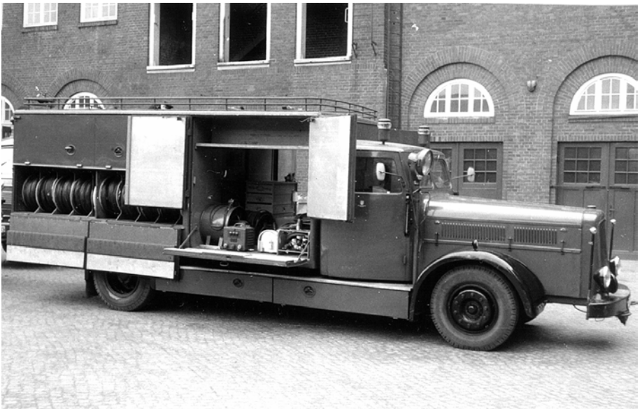
Der zweite „Werkstattzug“: umgebauter Schlauchkraftwagen S 4,5 auf KHD FS 145 (1)
