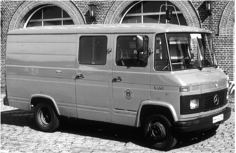
Dieser ehemalige Fernsprechkraftwagen (FeKw) des Bundes wurde zum Atmungsgerätemotorwagen ASGD umgebaut. Kastenwagen Mercedes-Benz 407 D (4)
