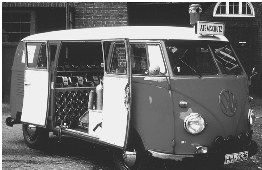
Der erste Atemschutzgerätewagen (damals „Gasschutzwagen“) wurde 1963 auf der Basis eines VW Typ 23 eingerichtet und war bis 1974 im Dienst (4)
