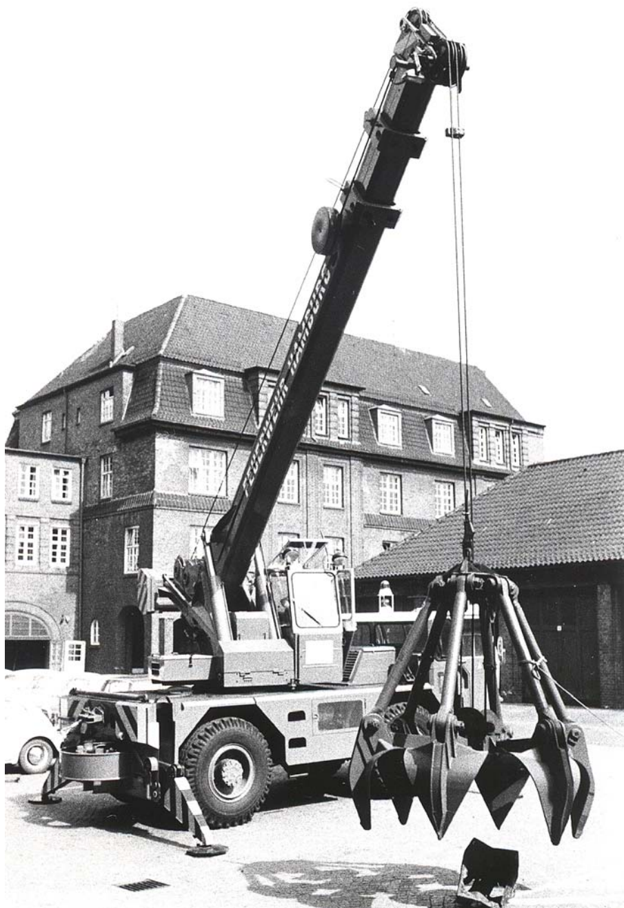
Der Feuerwehrkran FwK 20 konnte mit einem Mehrschalengreifer ausgerüstet werden (3)
