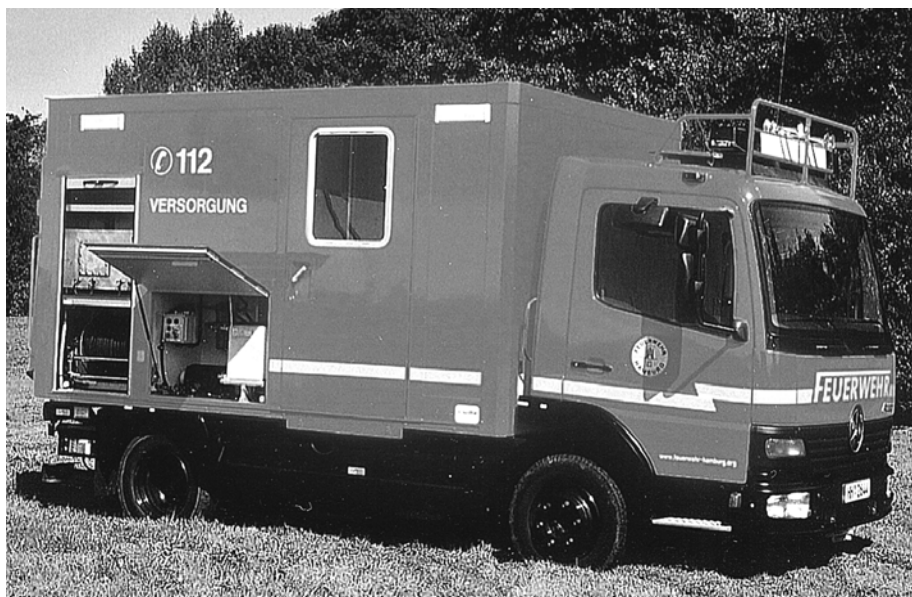
Gerätewagen „Versorgung“, Baujahr 2002, Fahrgestell: Mercedes-Benz Atego 812, Kofferaufbau: Firma Wille (4)
