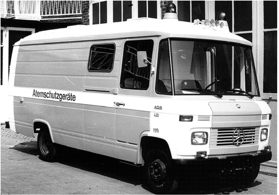
Der Atemschutzgerätewagen mit Überdruck-Atenschutzgeräten (ASGD). Kastenwagen Mercedes-Benz L 408, Ausbau: Herrmann. Im Dienst von 1970 bis 1984 (4)
