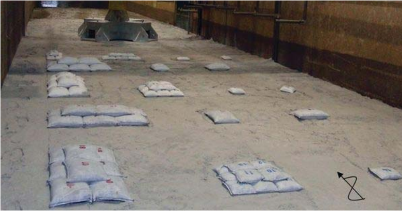
Abbildung 3: Anordnung der geotextilen Sandcontainertypen im Anfangszustand
