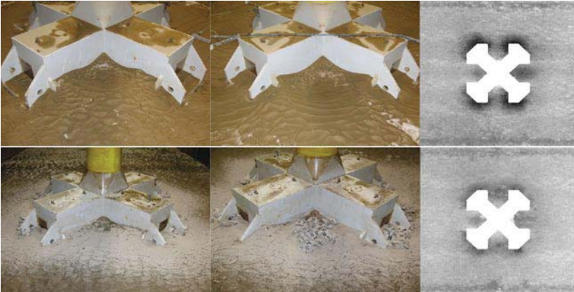
Abbildung 7: Zustand der Kolkentwicklung vor (links) und hinter (Mitte) dem Schaft, Ergebnisplot des Fächerecholots (rechts) nach 5000 Wellen. Wellenangriffsrichtung erfolgt von links. Versuch ohne Kolkchutz (oben). Versuch mit Kolkchutzmaßnahme Variante 3 (unten)
