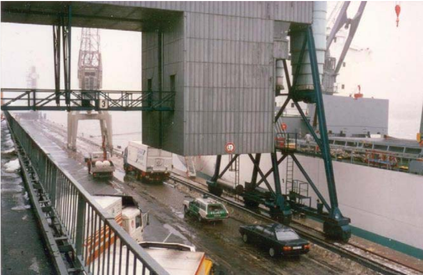
Bild 9: Bananenelevatoren mit doppelter Kranschiene und überlappenden Fahrwerken
