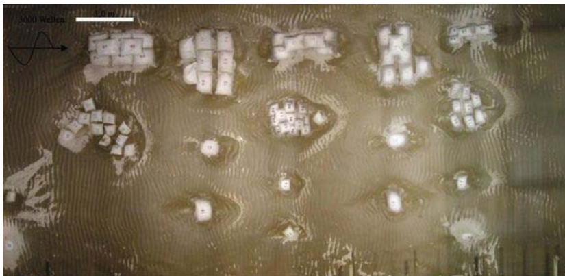
Abbildung 6: Zustand der Sandcontainer nach Belastung mit 3000 Wellen des 50-jährlichen Extremereignisses, Wellenangriffsrichtung erfolgt von links
