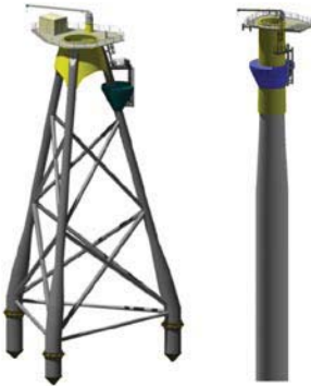
Abbildung 8 : Jacket und Monopile Struktur
