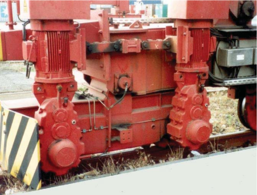
Bild 2: RMG Schwinge mit Wespentaille
