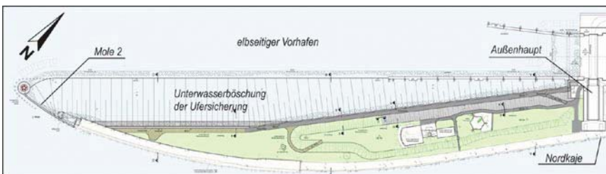
Abb. 3 Lageplan der Ufersicherung im elbseitigen Vorhafen
