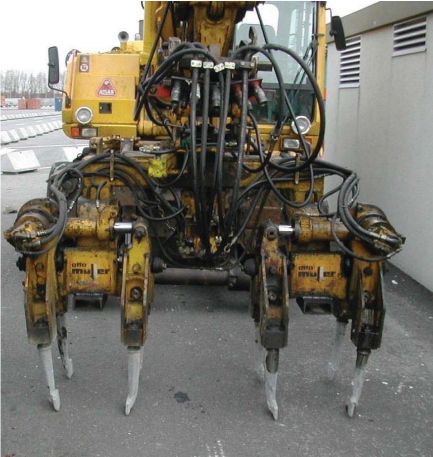
Bild 16: Stopfwerkzeug an einem Bagger
