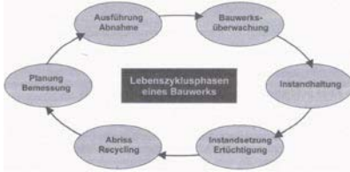
Abbildung 2: Lebenszyklusphasen von Bauwerken [5]
