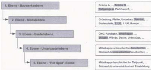
Abbildung 3: Hierarchische Systematik zur Bauwerkserfassung in fünf Ebenen [6]
