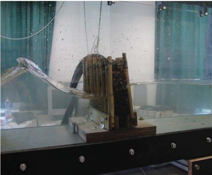
Abbildung 5: Physikalisches Modell einer Bambus-Lahnung
