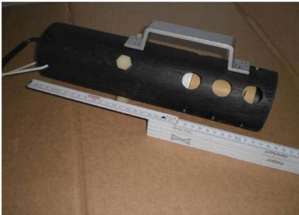
Ab. 23: Bezugslektrode Accu Ref 20 der Fa. Miller präpariert für Unterwasseranwendungen [12]
