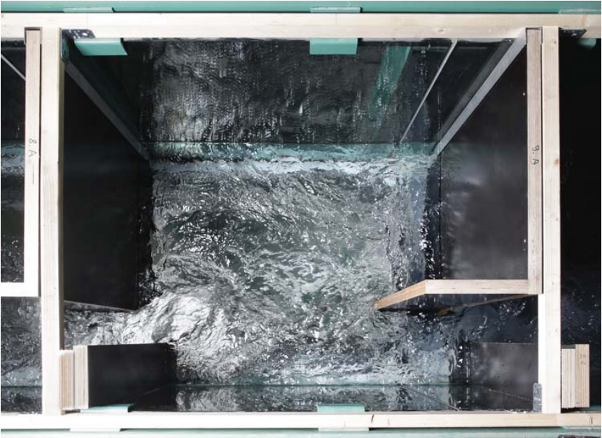
Bild 6: Strömungsfeld in einem Schlitzpass, Blick von oben.
