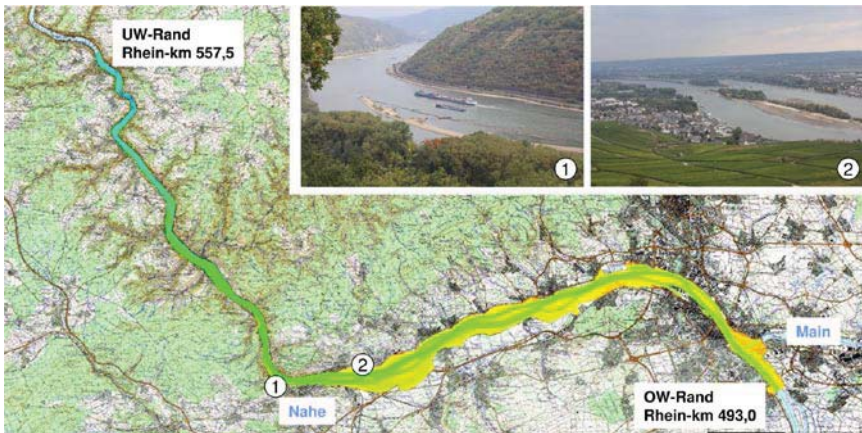
Bild 2: Ausdehnung des 2D-Modells Mainz – St. Goar (Bild o. l.: Blick in Fließrichtung auf die Binger Loch Strecke; Bild o. r.: Blick gegen die Fließrichtung auf die Rüdeshheimer Aue).
