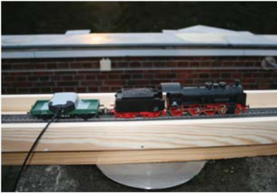
Abb.6: Modelleisenbahn mit montierter Antenne des GPS Empfängers
