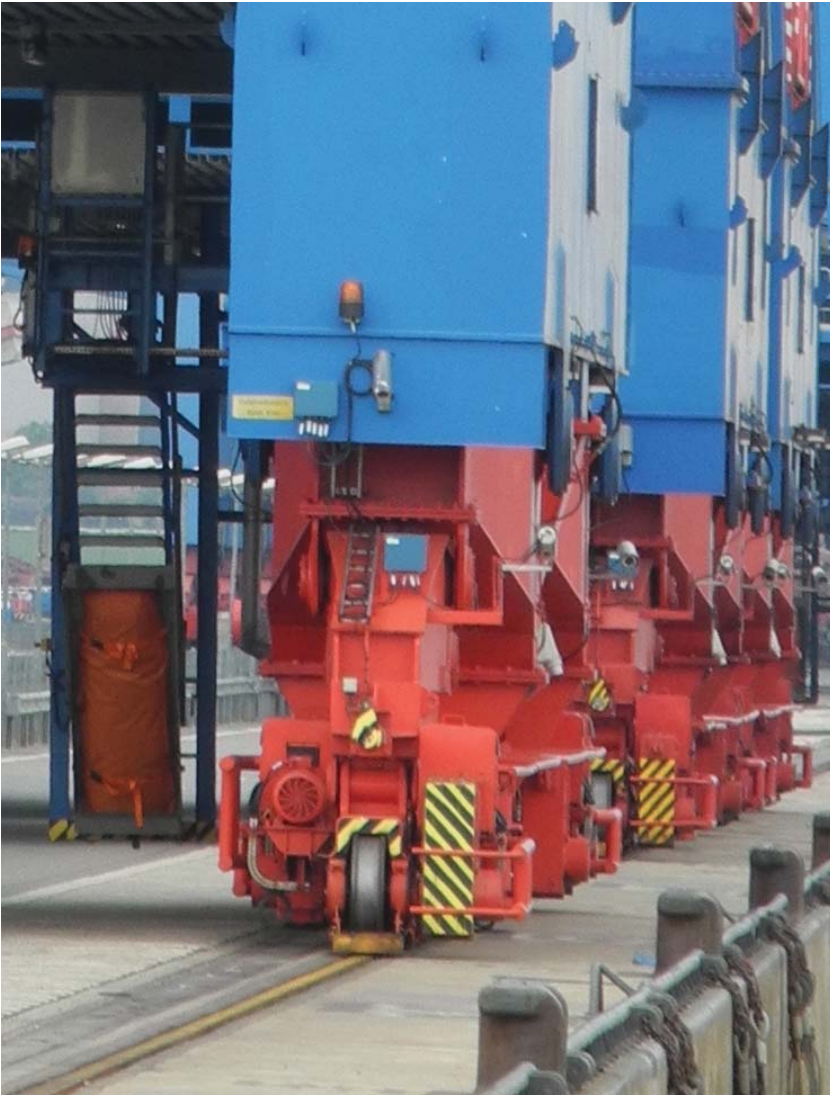
Bild 1: Wasserseitige Stütze eines Containerkrans mit Aufstieg.
