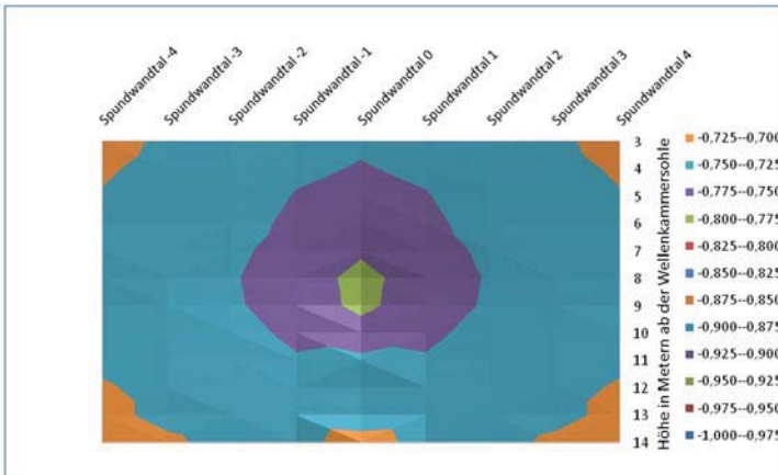
Bild 6: Grafische Darstellung des typischen Ausbreitungsfelds des Ausschaltpotentials beim Betrieb einer Einzelanode
