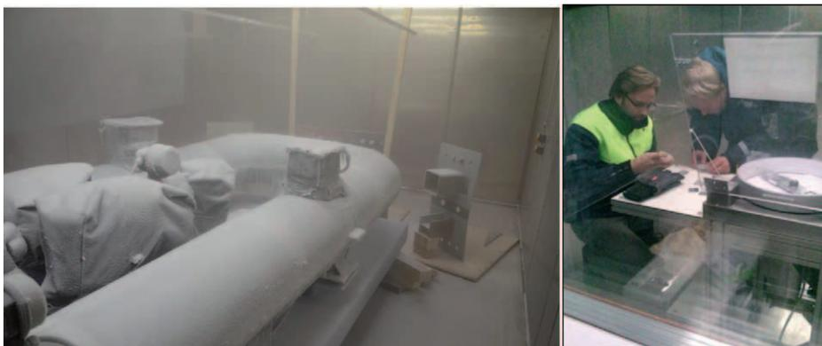
Abb. 2: Vereiste Rohrstruktur (links); Bestimmung der Haftfestigkeit von Eis auf Oberflächen im Rotationsprüfstand (rechts).
