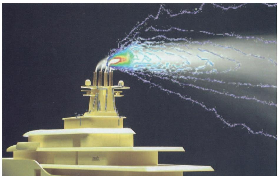
Rauchgaskonzentration eines Yachtmodells im Windkanal, überlagert mit der numerisch ermittelten Rauchgasfahne.
