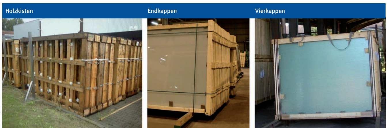
Abbildung 1: Typen von Holzpackmitteln
