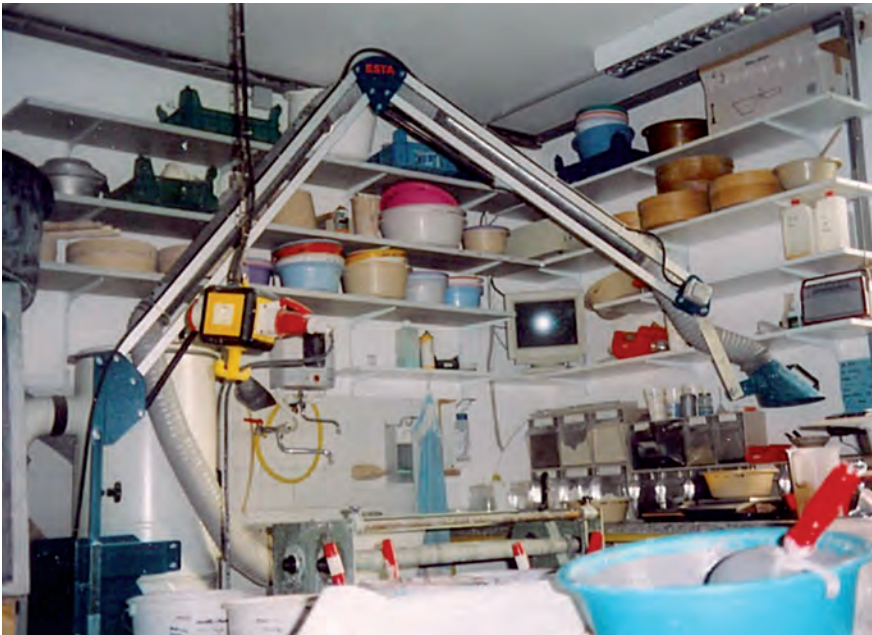
Abbildung 4: Glasuraufbereitung mit schwenkbarem Absaugarm
