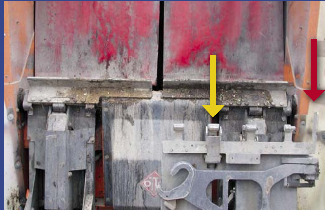
Abb. 2: Kammleiste mit Klappenschalter und Anschlag
